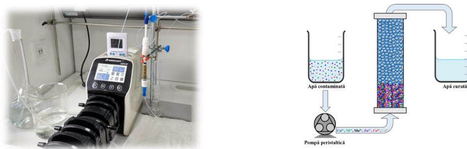
Figura 2. Instalația pentru evaluarea reținerii ionilor metalelor grele în regim dinamic.
